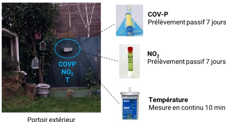
**Figure 17.** Mise en œuvre des prélèvements à l'extérieur du logement
